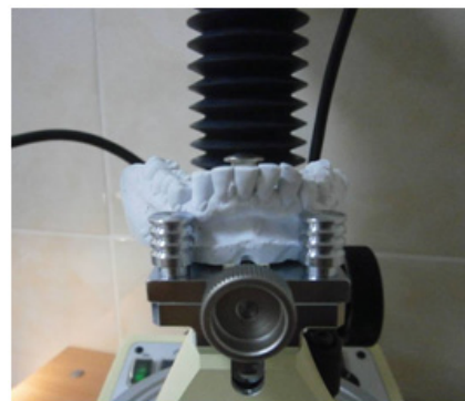
Рис. 2. Горизонтальное (нулевое) положение модели на столике параллелометра
