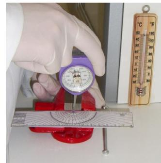
Рис 2. Контроль деформации дуги угломером
