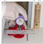
Рис 2. Контроль деформации дуги угломером
