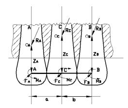
Рис. 2. Влияние силы и силового момента на перемещаемый и опорные зубы
